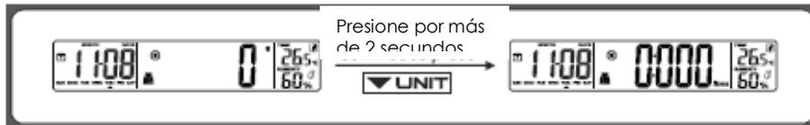
Nota: Si usted presiona brevemente el botón "Unidad", entrará en el modo medida de volumen agua/leche (mirar más abajo). Es necesario presionar continuamente el botón "Unidad" para ir de un sistema de medida a otro. El sistema predeterminado es imperial.
